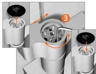
Kappe entfernen. Horizontalverstellung  $\pm 2,5$  mm. Kappe aufstecken.
