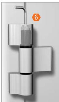
Lagerbuchse um  $\pm 90^\circ$  drehen bis sie spürbar einrastet.
