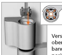
Verstellstern im oberen Rahmenbandteil positionieren.
